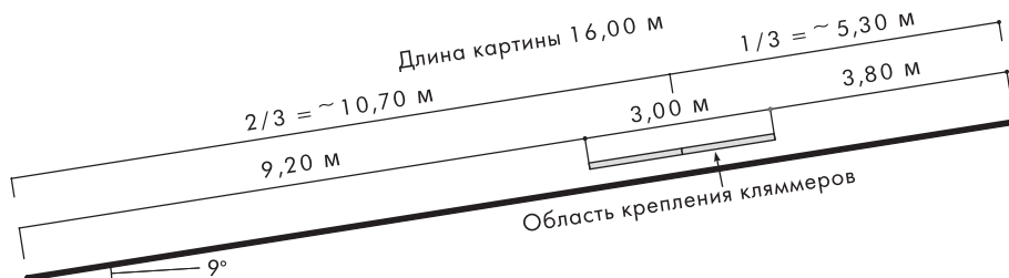
Схема 2.1: Пример односкатной кровли с уклоном 9°, длина картины 16 м
