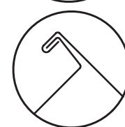
Рис. 21.3: Прямой фальц, односторонний
