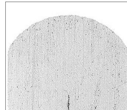
Фото 2.2: Образец, испытываемый на растяжение после загибания на 180°, без прокладки, параллельно направлению вальцевания
